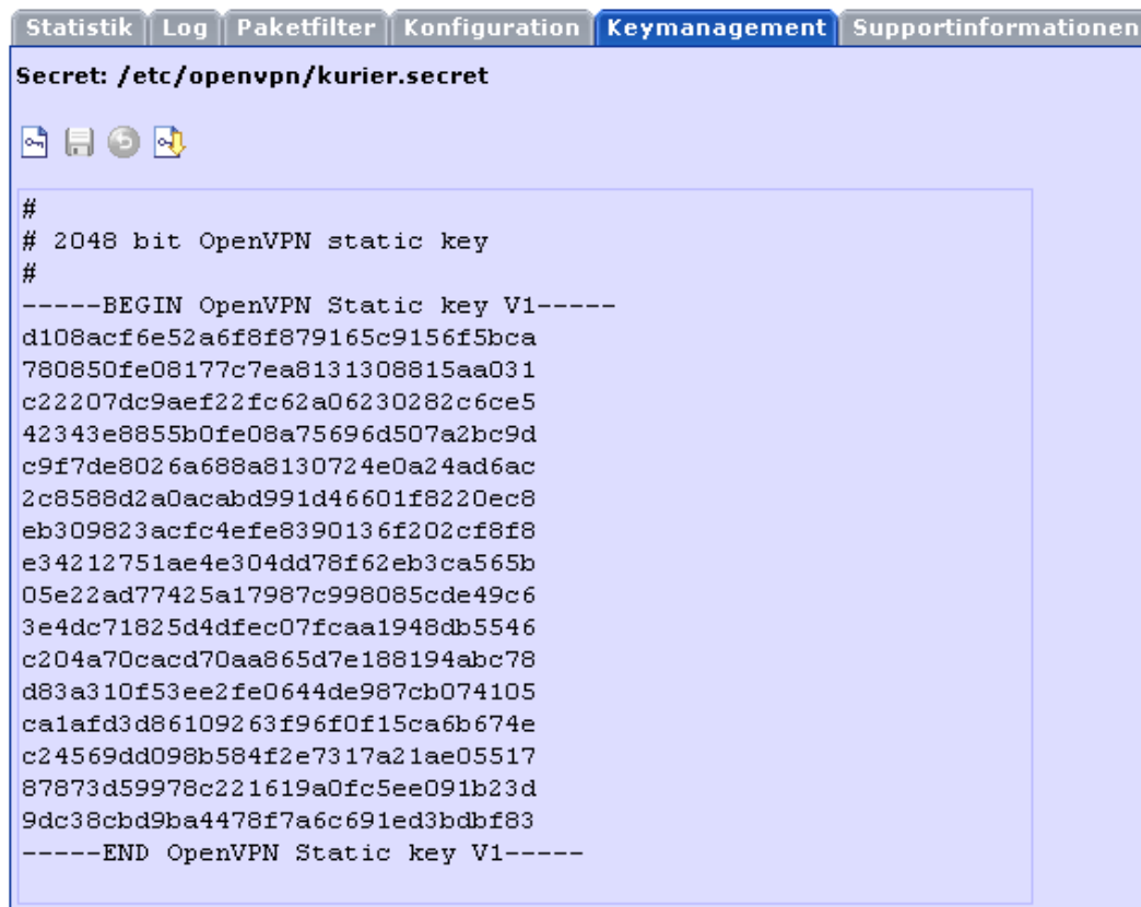
Abbildung 4.4.: Detailansicht einer Verbindung (Keymanagement)
